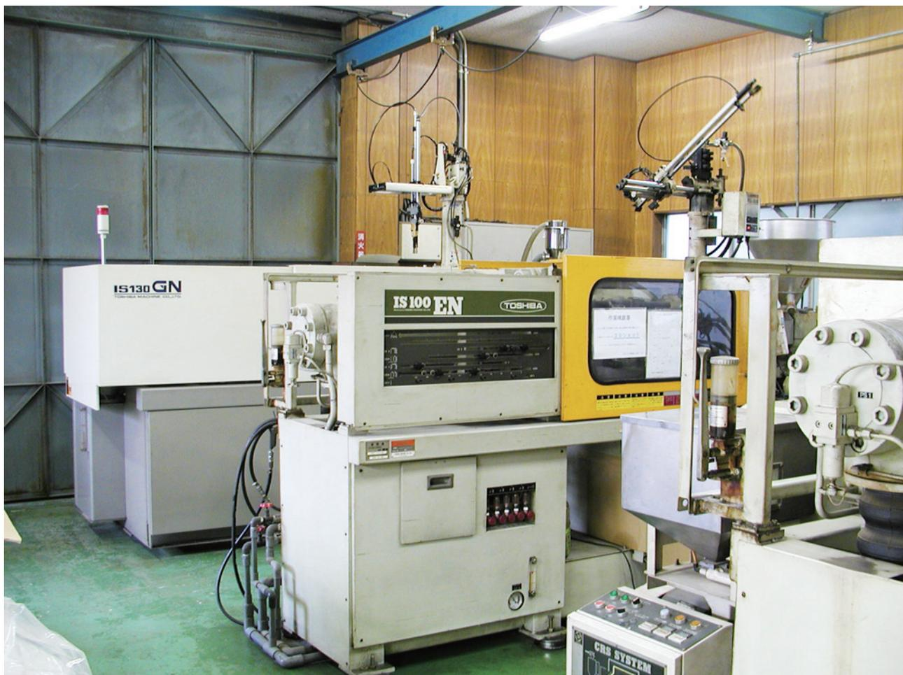
インジェクション(射出)成形は、プラスチック材料を溶かした状態で、金型に注入し圧力を掛けて成形する技術です。
